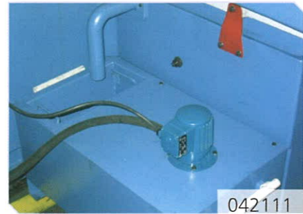
042111 Soğutma sistemi Cooling unit
