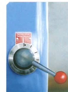
Hidrolik hız ayar, iş esnasında honlama strok hızını ayarlamayı sağlar. Hydraulic speed adjustment unit allows you to adjust honning stroke speed during the work.
