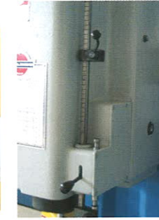
Sivş kutusu; strok ayarının kolay yapılabilmesi için kilepeler yerleştirilmiştir. Switch box; in order to allow practical stroke adjustment, wing screws are placed.
