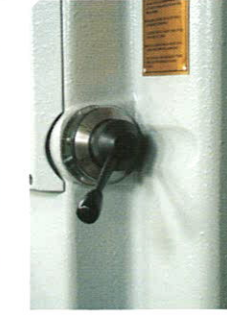
Hidrolik hız ayar ünitesi iş esnasında honlama strok hızını ayarlamayı sağlar. Hydraulic speed adjustment unit allows you to adjust honing stroke speed during the work.
