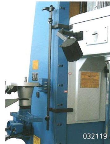
Aydınlatma lambası ve sınır siviçleri Lightening lamp and limit switch
