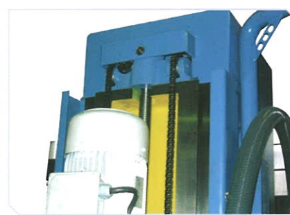
Çift zincirli ağırlık bağlantısı Dual chain transmission balance weight
