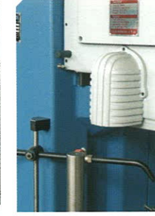
Yeni dizaynı ile aydınlatma lambası yenilenmiştir. Şanzuman hareket sınır sivişleri. Lithening lamp is renewed with its new design. Transmission movement limitation switches
