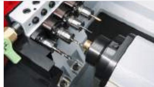
2. SPINDEL DES WERKZEUGS MIT RADIALANTRIEB
