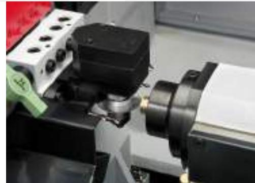
2. DREHWERKZEUGEINHEIT DER SPINDEL
