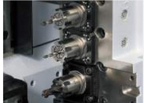
1. WINKELWERKZEUGEINHEIT DER SPINDEL
