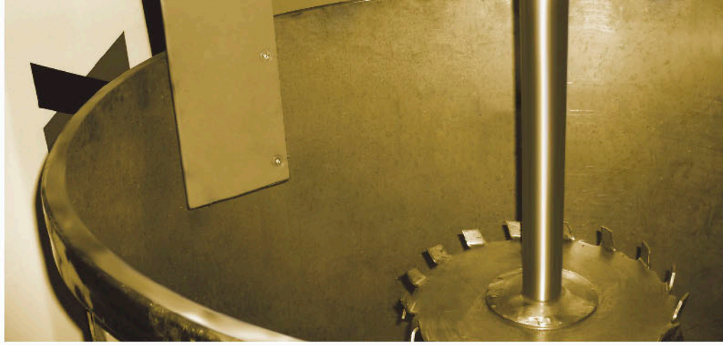
Dispersion Impeller Group Karıştırım Grubu
