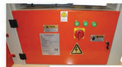
Önce İş Güvenliği ! Şalteri Kapatmadan Elektrik Panosunu Açamama.
