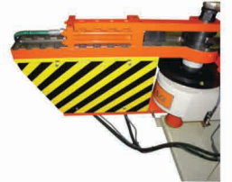
Mengene Pistonu Max. Radüsde Dahil Büküm Kolunun Üzerinde
