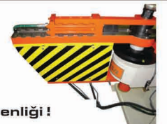
Emniyet Sacı / Büküm Kolunun Zamanla Sarkmasını Önleyen Kol Perdeleri ve Alt Kol
