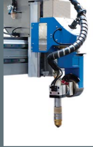
Kesim kafası, Z eksenini ile yukarı aşağı hareket ederken, X eksenini ile de sağa ve sola hareket etmektedir.
