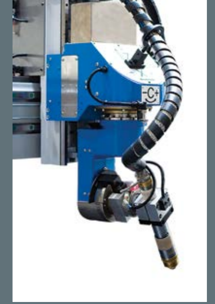
C ekseninde +140, -330 derece hareket alanıyla toplamda 470 derecelik bir hareket ve işlem açısına sahiptir.
