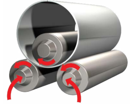
PLANET MERDANE SİSTEMİ Üst Merdane: ø 200-ø430 mm Sürücü: Tüm Merdaneler
