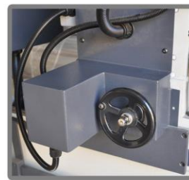
Karbür Bıçaklar İçin Motor Kontrollü Talaş Verme
