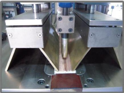
Kaynak sonrası aynı tabla üzerinde tavlama
