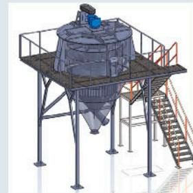
Автоматизированный контроль всех процессов помола и минимизация вероятности ошибок вот главный принцип производственной линии помола. Сырьё подлежащее помолу поступает в систему через бункер входа. Поступающее в этот бункер сырьё обладает определенной величиной частиц. Далее через дно бункера оно направляется на помол. Мельницы помола бывают двух видов шариковые и вальцевые. Выбор системы помола зависит от типа перемалываемого сырья и требуемой фракции на выходе.
