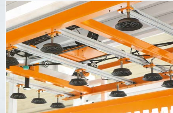
İşlenmemiş sac metali kaldırmak için vantuzlar: Yükleme paleti üzerinden kol kavrama yerleştirme yapar. Bu kolun görevi metal levha altındaki tarak cihazın girişine izin vermek için işlenmemiş sac metali almak ve sacı tarak üzerine yatırmaktır.
