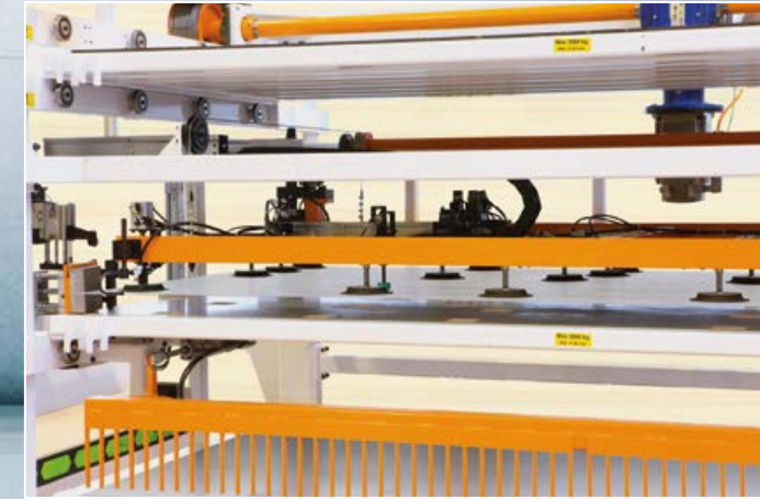
Stok Alanı: Otomatik sistem sac metali alır ve uygun stok alanına yerleştirir.
