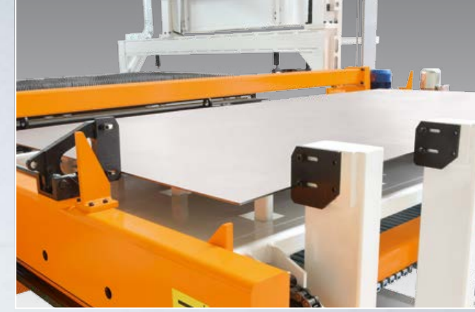
X Referans Kolu: Bu kol sac metali referanslamayı ve vantuz için hassas kullanımı sağlar.
