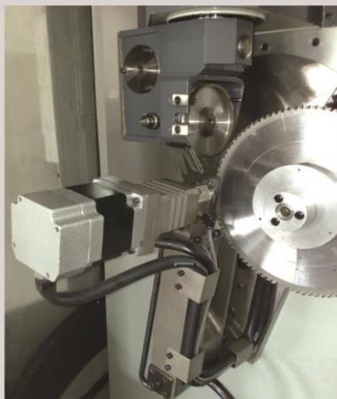
Patentli mikrostep sıkma ile otomatik et kalınlık, mesafe ve tork ayar imkanı
