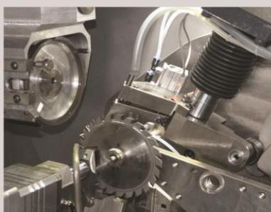
Akıllı tırmak ile otomatik kırk diş atlama ve şartsızlı diş adımlarını otomatik itme.
