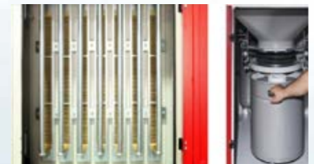
Filtreler ve toz kovası mekanizmasına kolay erişim
