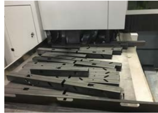
Konveyörlü otomatik boşaltma sistemi ile 6m uzunluğa kadar boru ve profiller tahliye edilir.
