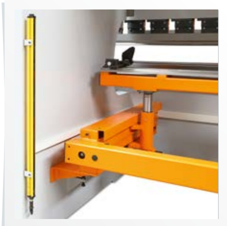
C 2000 Arka Işık Bariyeri (S) CE standartlarına uygun koruma önlemleri daha güvenli çalışmanıza yardımcı olur.
