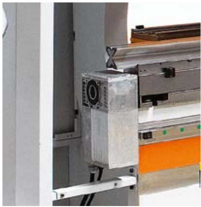
Motorlu Bombeleme Sistemi (S) CNC kontrolörle haberleşip otomatik bombeleme yaparak, bükülen parçanın her noktada ve eşit büküm açısında olmasını sağlayan motorlu bombeleme sistemi.
