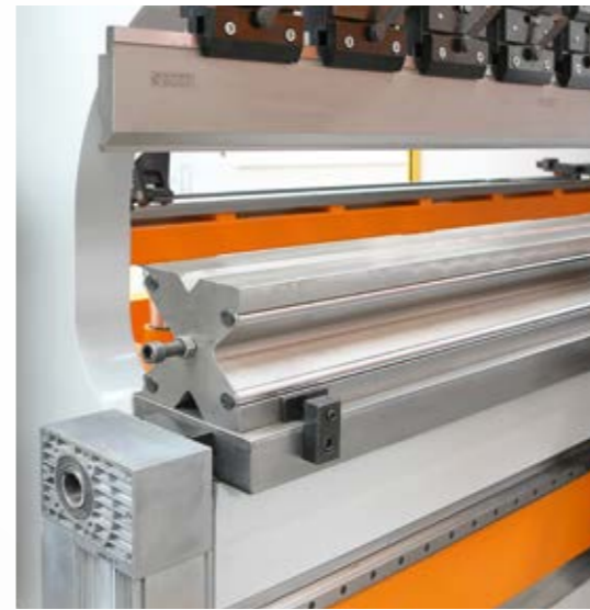
Boğaz (O) Geniş bükümler için 1500 mm'ye kadar özel boğaz derinliği sunulmaktadır.
