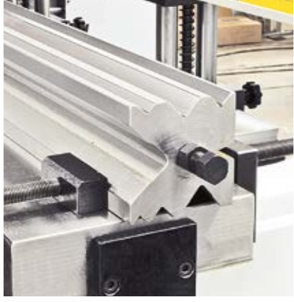
Çoklu Alt Kalıp (O) Multi V ya da U tipi ayarlanabilir kalıplar.
