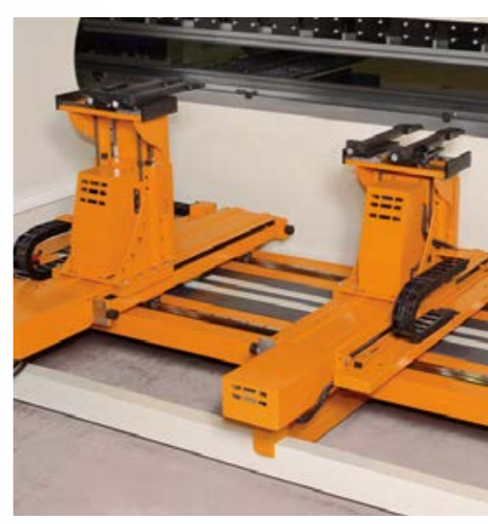
6 Eksen Servo Motorlu Arka Dayama (O) 6 eksen (X1+X2+R1+R2+Z1+Z2) servo motorlu hızlı ve hassas arka dayama sistemleri. Üretim verimliliği ve kalitesini arttırmaya olanak sağlar.
