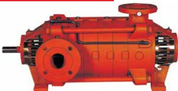
Yatay milli, radyal ayrılabilir gövdeli, çok kademeli, kapalı çarklı, difüzörlü santrifüj pompalarıdır.
