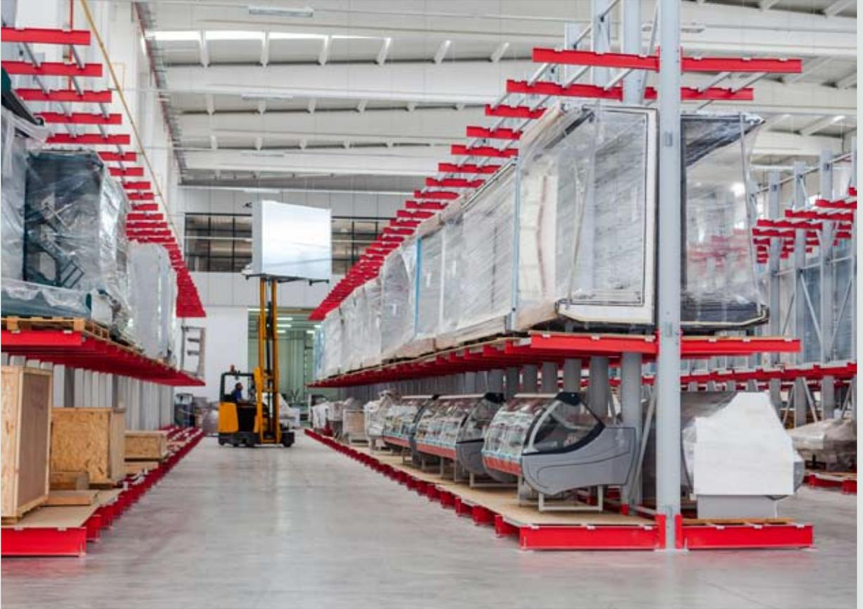
→ Farklı ağırlık ve ölçülerdeki ürünler, yan yana konularak, istenen uzunlukta, aralıksız olarak depolanabilir. Depodaki konuma göre tek yönlü ve çift yönlü olarak uygulaması yapılabilir.
