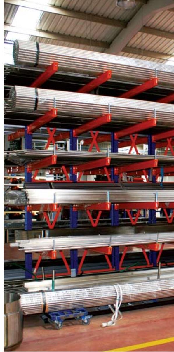
➔ İstiflenecek ürünlerin ebat ve ağırlıklarına göre sistemde kullanılacak taşıyıcı kolon ve konsol kolların kesit özellikleri değişkendir. Kullanılacak istifleme cihazı ve deponun yüksekliğine bağlı olarak sistemin yüksekliği ve konsollar arasındaki mesafe ayarlanabilir.
