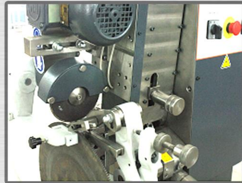
HSS Daire Testere Manuel Sağ/Sol Pah Kırılması
